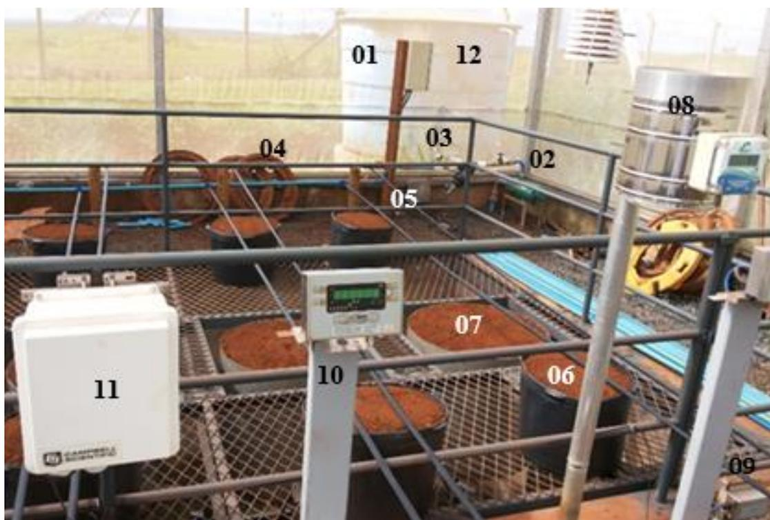
**Figura 2** - Disposição parcial do sistema de irrigação
